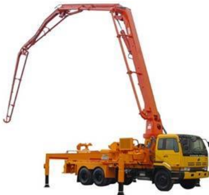
1.1 Сурет - Жүк машинасына орнатылған гидравликалық бақыланатын бетон сорғы машинасы
